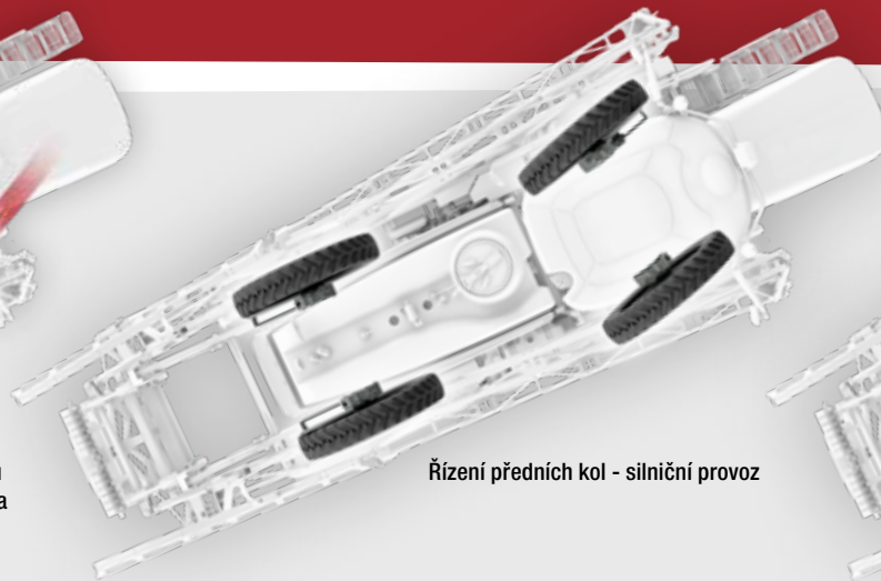
Standardní režim řízení 4 kol v terénu lze rozšířit o inteligentní funkci „cesta v cestě“, která umožňuje, aby zadní kola byla vždy 100% ve stopě.
